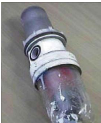
Rys. 11. Filtr powietrza używany w lakierni samochodowej
